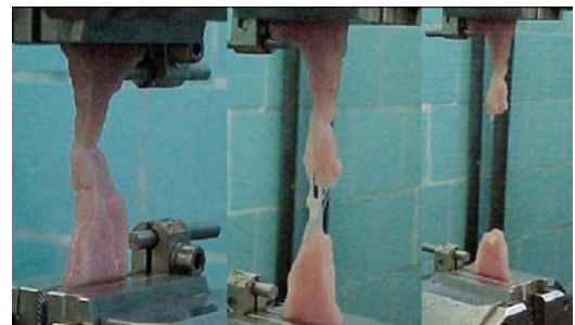
FIGURA 4 – Sequência de rotura de um corpo de prova, submetido a ensaio tensiométrico
