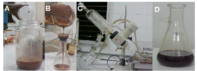
FIGURA 1 – Processo de obtenção do extrato da Passiflora edulis : (a) mistura da solução hidroalcoólica a 70% ao pó de P. edulis ; b) filtração da mistura em funil e algodão; c) extrato bruto concentrado em evaporador rotativo para eliminação do solvente; d) extrato bruto de Passiflora edulis de coloração verde-escuro
